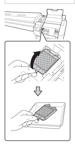
Inserire i due ganci sul tampone di assorbimento nelle fessure della stampante e premere la linguetta verso il basso fino a quando il tampone scatta in posizione.
