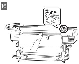
Stringere il supporto con una mano, tirarlo finché non è allineato con il bordo inferiore dell'etichetta sul post-riscaldatore.
