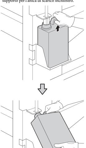
Inserire il tubo dell'inchiostro di scarto nella bocca della nuova Tanica di scarico inchiostro e posizionare la Tanica di scarico inchiostro nel supporto.
