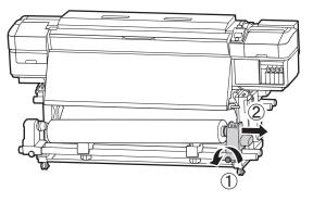
Abbassare il rotolo sull'appoggio per rotolo.
