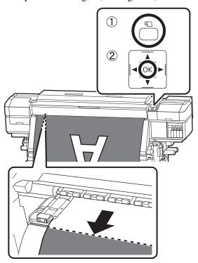
Se è stata stampata la quantità di supporto residuo, premere il tasto ▲ per riavvolgere il supporto in modo che tale informazione rimanga sul rotolo dopo il taglio del supporto. Quando si usa il Riavvolgitore automatico, alzare la barra di tensione.
