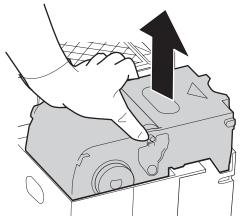
Per evitare di sporcare l'ambiente circostante con l'inchiostro, avvolgere l'unità wiper utilizzato nell'imballaggio fornito con la nuova unità wiper.
