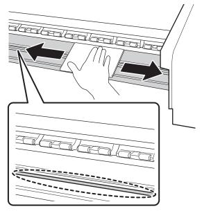
Immergere un panno morbido in acqua, strizzarlo bene, ed eliminare filamenti o polvere sulle piastre laterali del supporto.
