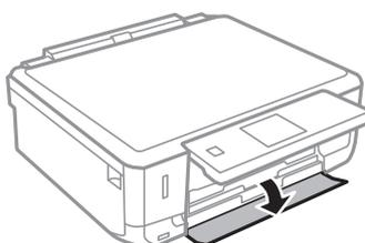
3. Vérifiez que l'imprimante n'est pas en cours de fonctionnement, puis retirez le bac papier 1. Le Bac papier 1 dispose d'un repère d'alignement
