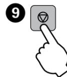
9 Naciśnij . Ładowanie tuszu zostało rozpoczęte. Apăsați pe . Începe încărcarea cu cerneală. Stlačte tlačidlo . Dopĺňanie atramentu je spustené.
