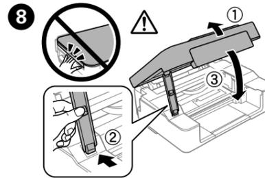
8 Zamknij jednostkę skanera. Închideți scannerul. Zatvorte jednotku skenera.
