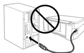
Kabel USB należy podłączyć dopiero po wyświetleniu takiego polecenia.
