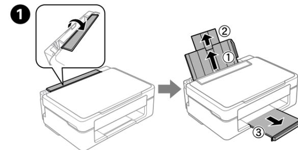
Przewróć osłonę podajnika, a następnie wysuń podpórkę papieru i tacę wyjściową.
