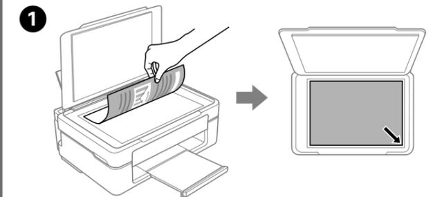
Otvórz pokrywę i umieść dokument na szybie skanera zadrukowaną stroną do dołu. Wyrównaj dokument z prawym przednim rogiem szyby.
