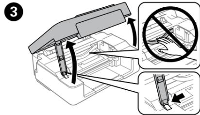
3 Otwórz moduł skanera i naciśnij . Nastąpi przesunięcie głowicy drukującej. Jeśli głowica drukująca nie przesunie się, przytrzymaj przez 6 sekund lub dłużej, aż do jej przesunięcia.
