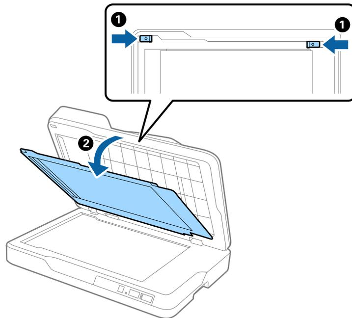
6. Verwenden Sie ein weiches, sauberes und trockenes Tuch, um die durchsichtigen Teile auf der Rückseite des Vorlagenpolsters zu reinigen.
