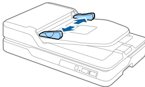
2. Legen Sie die Originale gerade in das Eingabefach ein, mit der Bild- bzw. Textseite nach oben und der Vorderkante in Richtung des ADF.
