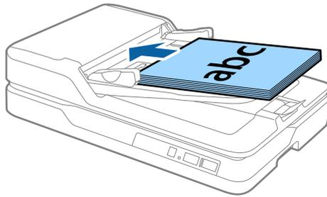
4. Verschieben Sie die Führungsschienen bündig an die Kanten der Originale und achten Sie darauf, dass kein Spalt zwischen Führungsschiene und Papierkante entsteht. Die Originale könnten sonst schief eingezogen werden.
