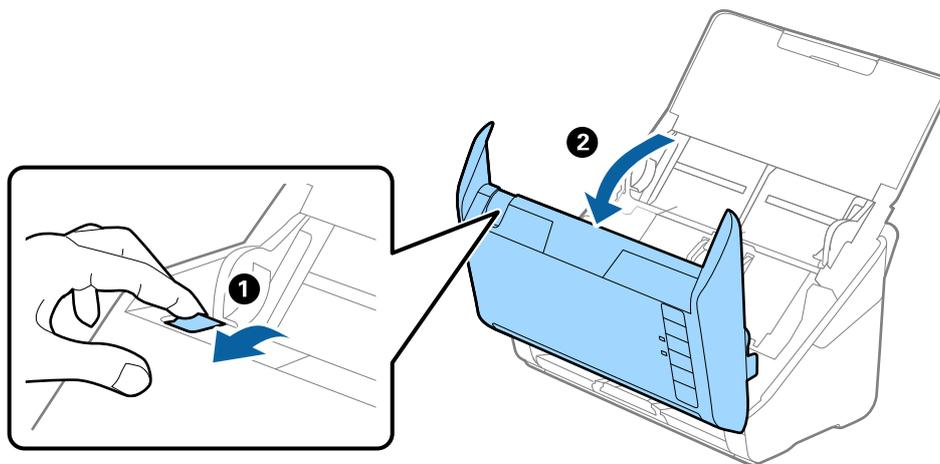
4. Pulire eventuali macchie sul rullo di plastica e sulla superficie di vetro nella parte interna del coperchio dello scanner con un panno morbido o usando il kit di pulizia Epson.
