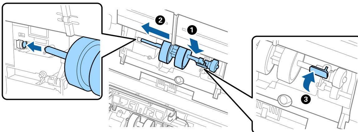
7. Mettere il bordo del coperchio del rullo raccogliitore nella scanalatura e farlo scorrere. Chiudere il coperchio saldamente.
