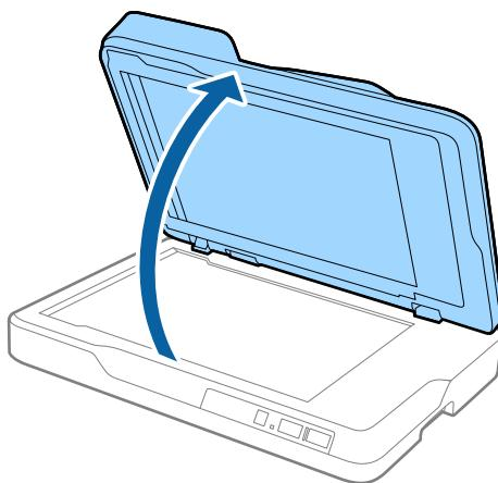
2. Postavite original licem okrenutim nadole na staklo skenera i uverite se da je gornji ugao strane koju želite da skenirate postavljen uz ugao skenera pored oznake strelice.
