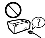
Χρησιμοποιείτε αποκλειστικά και μόνο το καλώδιο τροφοδοσίας που παρέχεται με τον εκτυπωτή. Η χρήση άλλου καλώδιου μπορεί να προκαλέσει πυρκαγιά ή ηλεκτροπληξία. Μην χρησιμοποιήστε το καλώδιο με οποιονδήποτε άλλο εξπλισμό.
