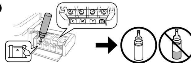
Prirovňajte farbu atramentu k zásobníku a potom ho úplne naplňte atramentom. Potriviti culoarea cernelii cu rezervorul și apoi alimentați cu toată cerneala. Изберете цвета на мастилото според резервоара, после го напълнете с цялото мастило. Mürekkep rengini tankla eşleştirin ve sonra tüm mürekkebi doldurun.
