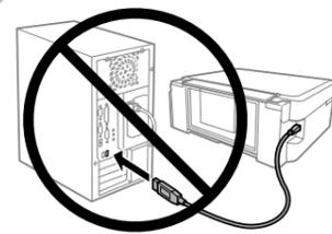
Nepripájajte kábel USB, kým sa neobjaví pokyn na jeho pripojenie. Nu conectați cablul USB decât atunci când vi se cere acest lucru. Не свързвайте USB кабел, докато не получите инструкции за това. Sizden istenmediği sürece bir USB kablosu bağlamayın.
