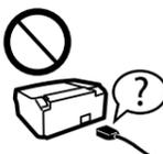
Používajte iba napájací kábel, ktorý sa dodáva s tlačiarňou. Pri použití iného kábla hrozí požiar alebo úraz. Nepoužívajte kábel s iným zariadením.
