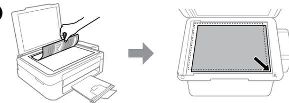
Otvorte kryt dokumentov a položte originál na sklo skenera potlačenou stranou nadol. Zarovnajte originál podľa pravého horného rohu skla.
