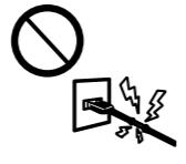
Nedovolte, aby sa napájací kábel poškodil, prípadne rozdrobal.
