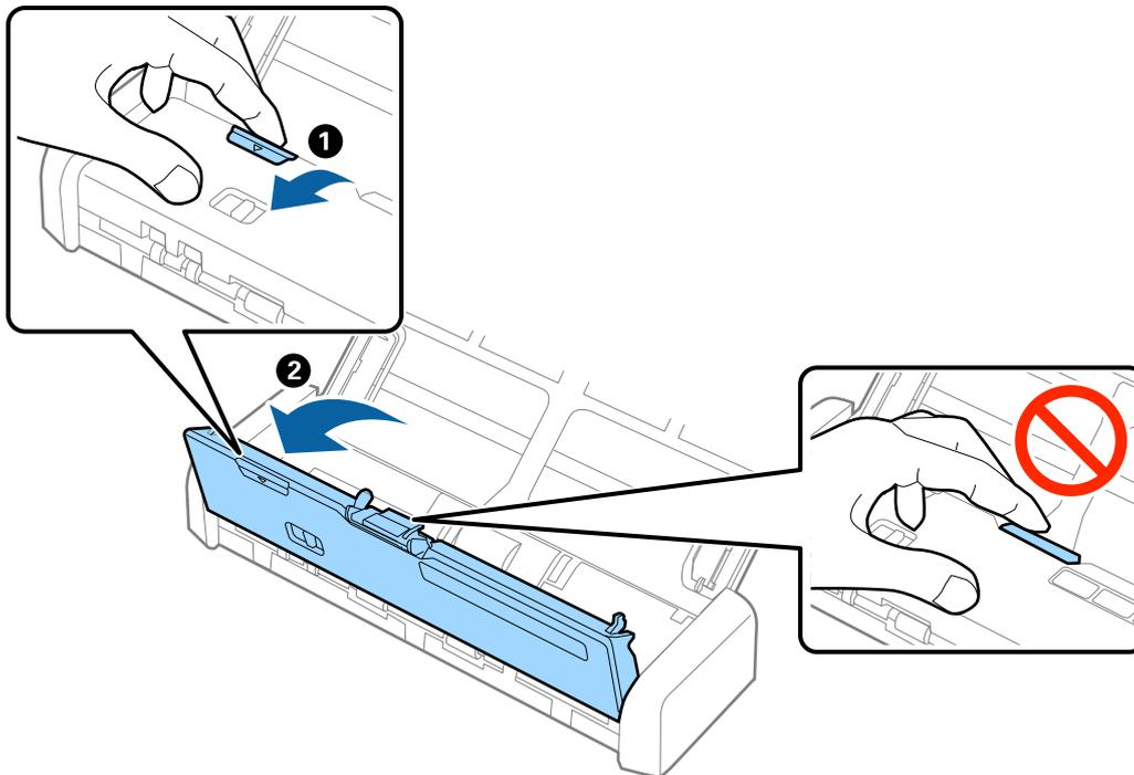
4. Uхватite kuke na obje strane podloge za odvajanje i uklonite je.
