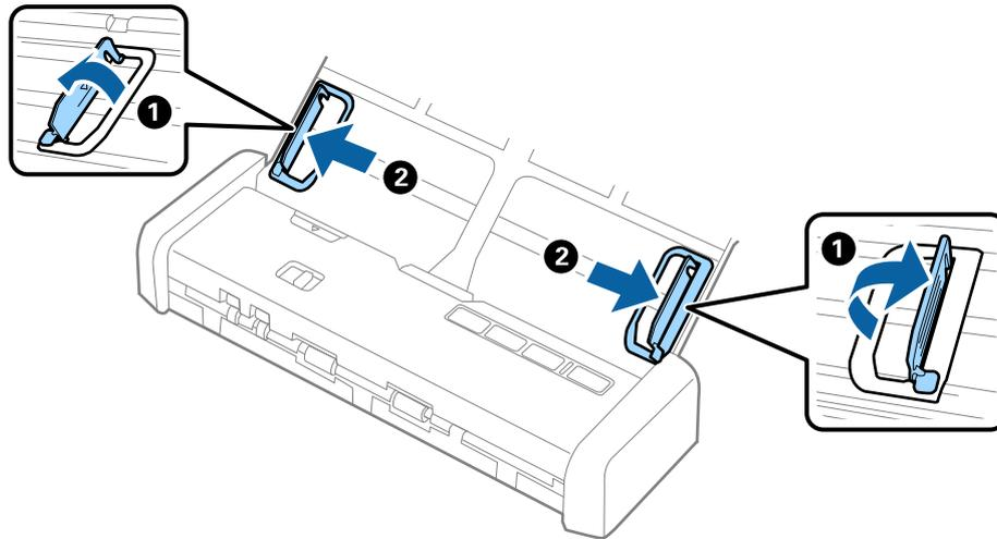
4. Umetnite debele izvornike u ulazni pretinac koji je okrenut dolje s gornjim rubom usmjerenim u ADF. Gurnite debele izvornike u ADF dok ne naiđu na otpor i dok lampica pripravnog stanja ne postane svjetlija.
