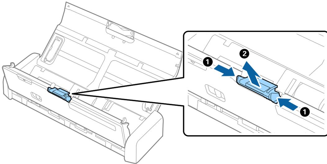
6. Mekanom krpom obrišite mrlje s podloge za odvajanje.
