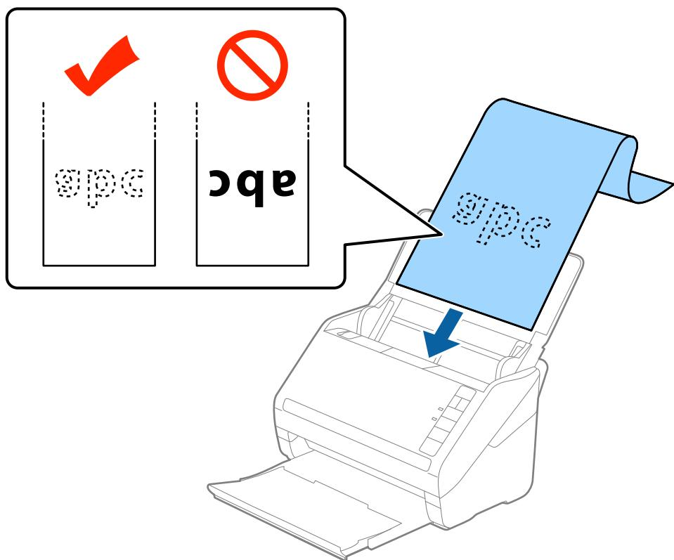
4. راهنمای لبه را با لبه کاغذ بلند تنظیم کنید و اطمینان حاصل کنید که هیچ فاصله ای بین لبه کاغذ و راهنمای لبه وجود نداشته باشد. در غیر این صورت ممکن است سندها به صورت کج تغذیه شوند.
