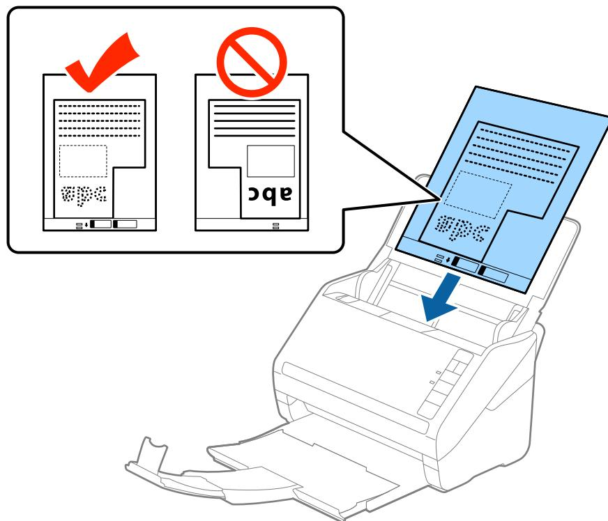
5. راهنمای لبه را بلغزانید تا با لبه برگه حامل تنظیم شوند و اطمینان حاصل کنید که هیچ فاصله ای بین برگه حامل و راهنمای لبه وجود نداشته باشد. در غیر این صورت ممکن است برگه حامل به صورت کج تغذیه شود.
