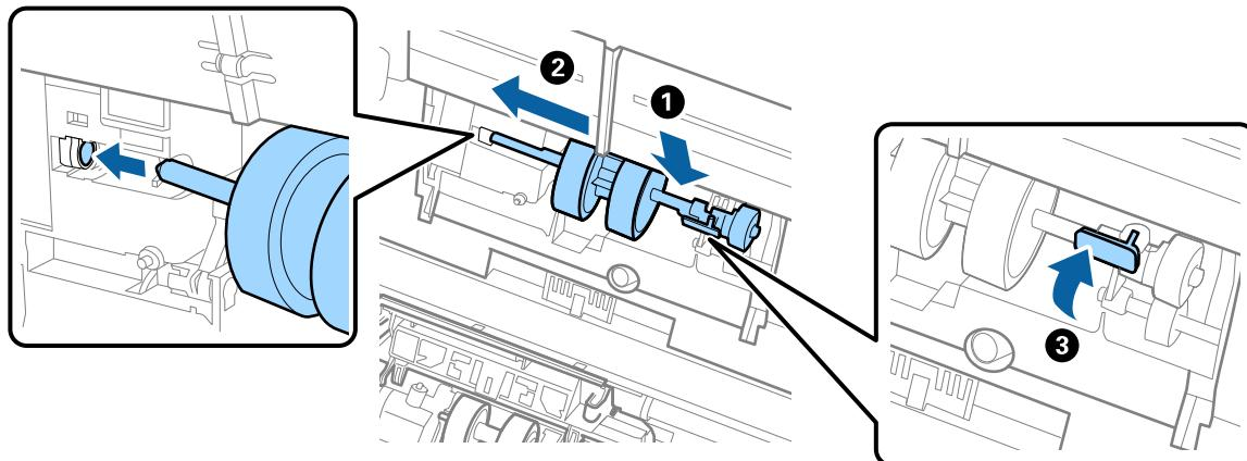
7. لب روکش غلتک بلندکننده را داخل شیار قرار داده و بلغزانید. روکش را محکم بیندید.
