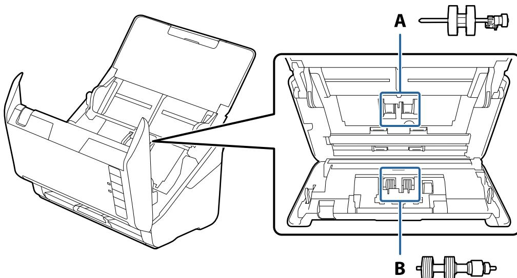
A: غلتک بلندکننده، B: غلتک جداکننده
