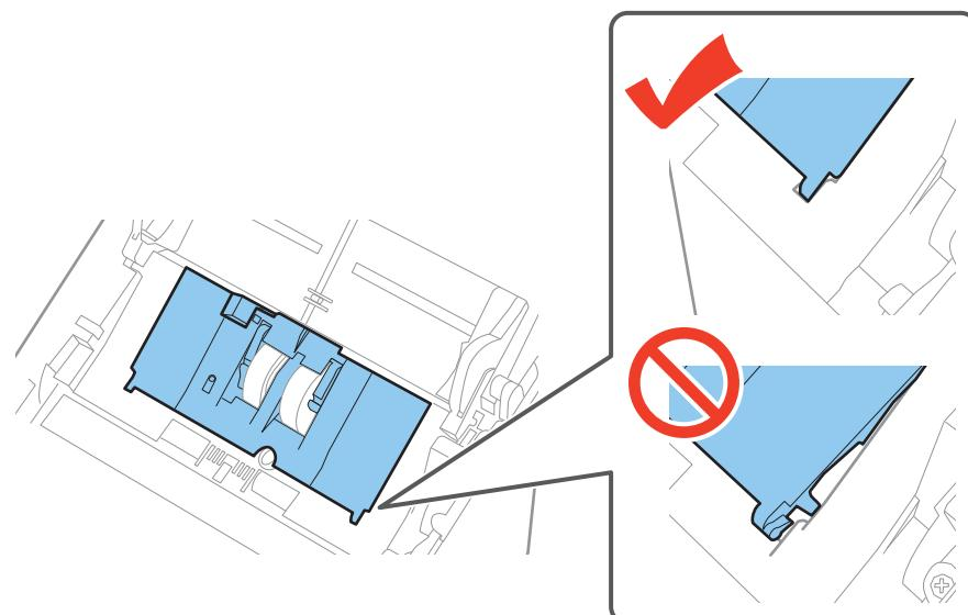
.8. قلاب های دو طرف انتهایی روکش غلتک جداکننده را فشار دهید تا روکش باز شود.
