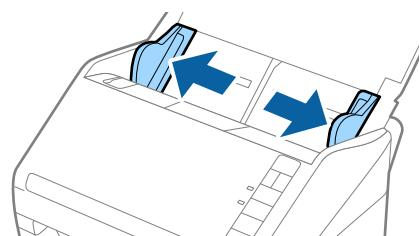
3. کارت های پلاستیکی را طوری در داخل سینی ورودی قرار دهید که رو به پایین باشند و لبه بالایی رو به ADF باشد.
