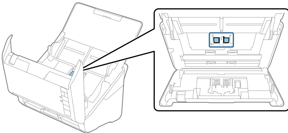
9. هرگونه گرد و خاک یا کنیفی روی غلتک انتخاب را با استفاده از کیت تمیزکننده اصل Epson یا یک پارچه نرم و مرطوب تمیز کنید.
