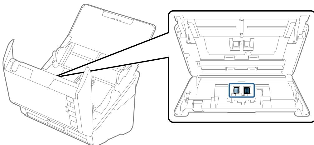
7. هرگونه گرد و خاک یا کثیفی روی غلتک جداکننده را با استفاده از کیت تمیزکننده اصل Epson یا یک پارچه نرم و مرطوب تمیز کنید.
