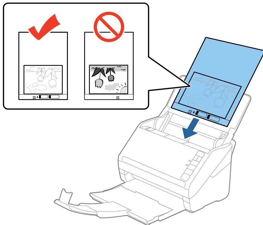
5. راهنمایی‌های لبه را بلغزانید تا با لبه برگه حامل تنظیم شوند و اطمینان حاصل کنید که هیچ فاصله‌ای بین برگه حامل و راهنمایی‌های لبه وجود نداشته باشد. در غیر این صورت ممکن است برگه حامل به صورت کج تغذیه شود.
