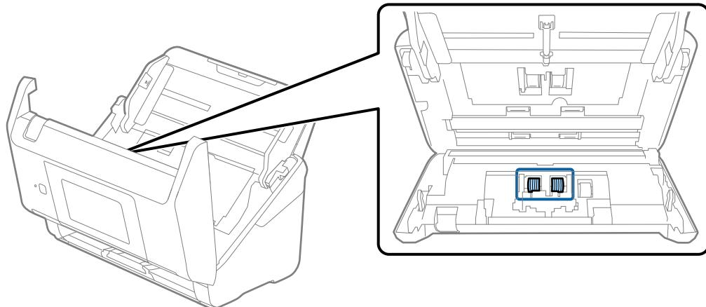
7. Obrišite prašinu ili nečistoće na valjku za razdvajanje pomoću originalnog Epsonovog pribora za čišćenje ili meke, vlažne krpe.
