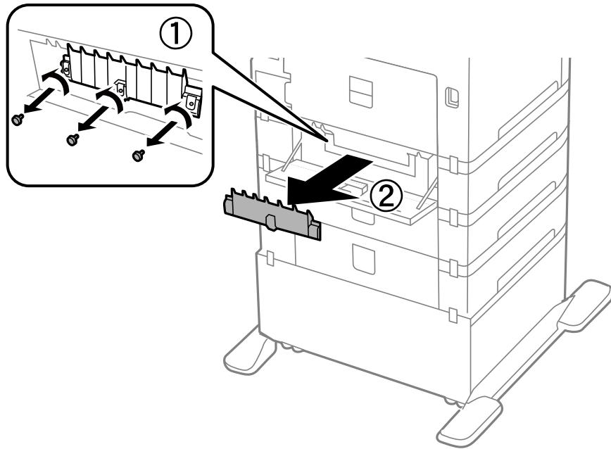
6. Izvucite dva iskorištena valjci za održavanje i uklonite ih.
