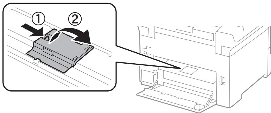
7. Izvucite dva iskorištena valjci za održavanje i uklonite ih.
