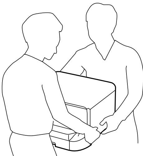
❑ При перемещении принтер не следует наклонять более чем на 10 градусов. В противном случае он может упасть.
