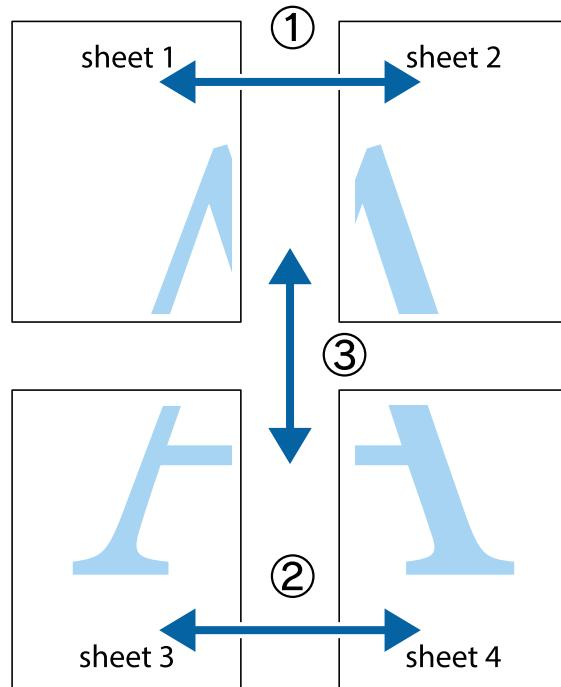
1. Подготовьте Sheet 1 и Sheet 2. Отрежьте поля Sheet 1 по синей вертикальной линии, проходящей через центр верхней и нижней метки пересечения.
