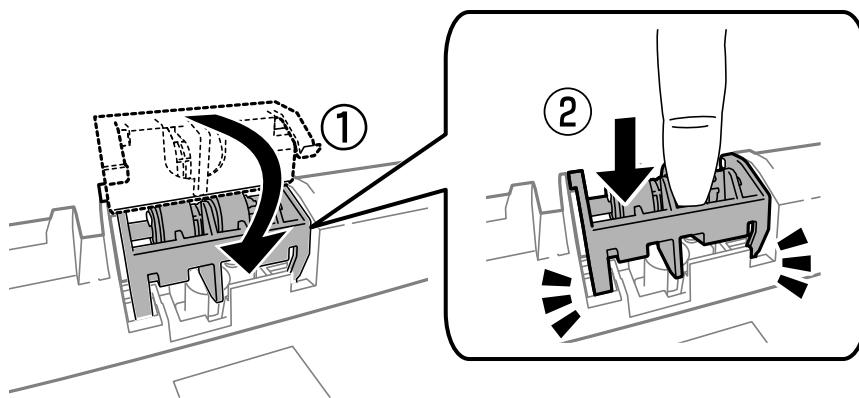
13. Вставьте заднюю крышку 2, закройте заднюю крышку 1, а затем вставьте кассета для бумаги.
