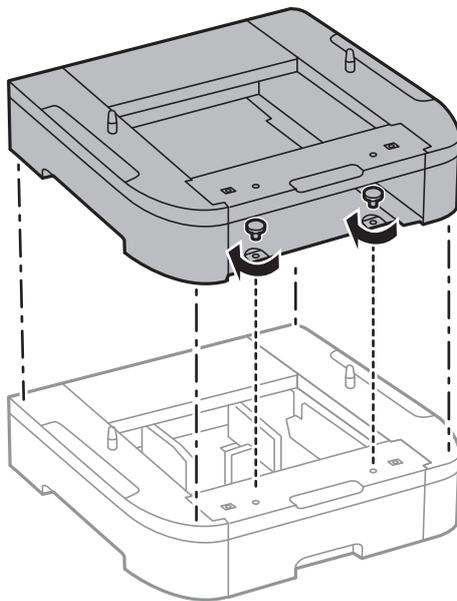
8. Осторожно опустите принтер на дополнительную кассету для бумаги, так, чтобы совпали углы, и с помощью отвертки закрепите по углам винтами.
