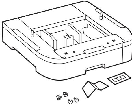
5. Поставьте дополнительную кассету на место установки принтера.
