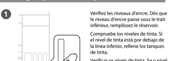
Vérifiez les niveaux d'encre. Dès que le niveau d'encre passe sous le trait inférieur, remplissez le réservoir.
