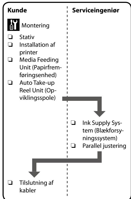
Pyydä huoltoteknikko liittämään Ink Supply System ja suorittamaan suuntauksen säädön Automaattinen kiinniottorulllaysikkö-yksikköön. Jos yrität tehdä näitä tehtäviä itse, saatat vaurioittaa tulostinta tai aiheuttaa sen toimintahäiriön. Huomaathan, että Epson ei ota mitään vastuuta näin aikaansaadusta vaurioista tai toimintahäiriöstä.
