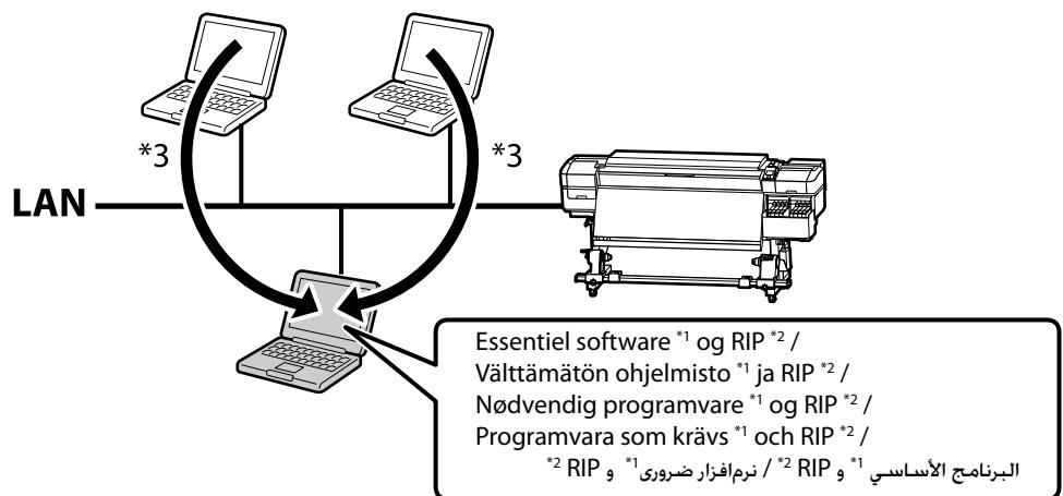
\*1 Består af fire følgende programmer: Epson Control Dashboard, EPSON Software Updater, EPSON Manuals, og Epson Communication Driver.
