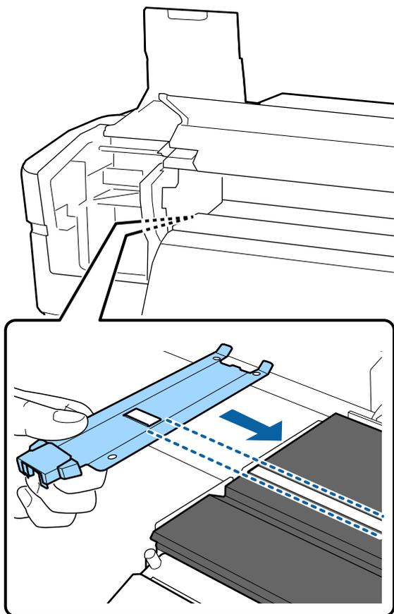
(2) При прижатии конца металлической пластины к валу прикрепите загнутую секцию к переднему углу вала.
