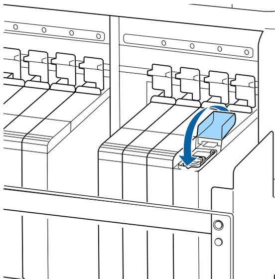
Если чернила налипают на теплоизоляционную защиту при перезаправке чернил, снимите теплоизоляционную защиту и очистите ее.
