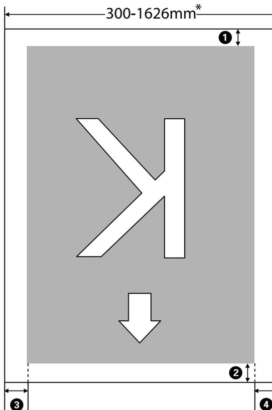
\* Если для параметра Проверка размера носителя задано значение **Выкл**, этот показатель равен 1626 мм (64 дюйма) независимо от ширины загруженного носителя.
