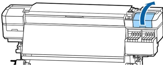
**4** Вставьте пальцы в канавку на тыльной стороне абсорбера и наклоните его немного вперед.
