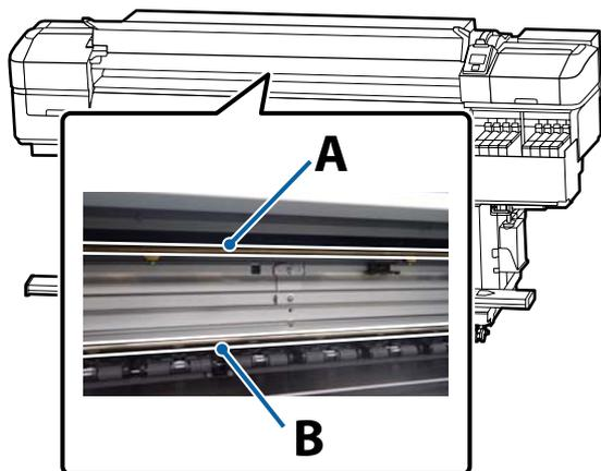
Есть два стержня каретки: стержень А и стержень В. Нанесите смазку на оба стержня, используя комплект для смазки, входящий в комплект поставки принтера.
