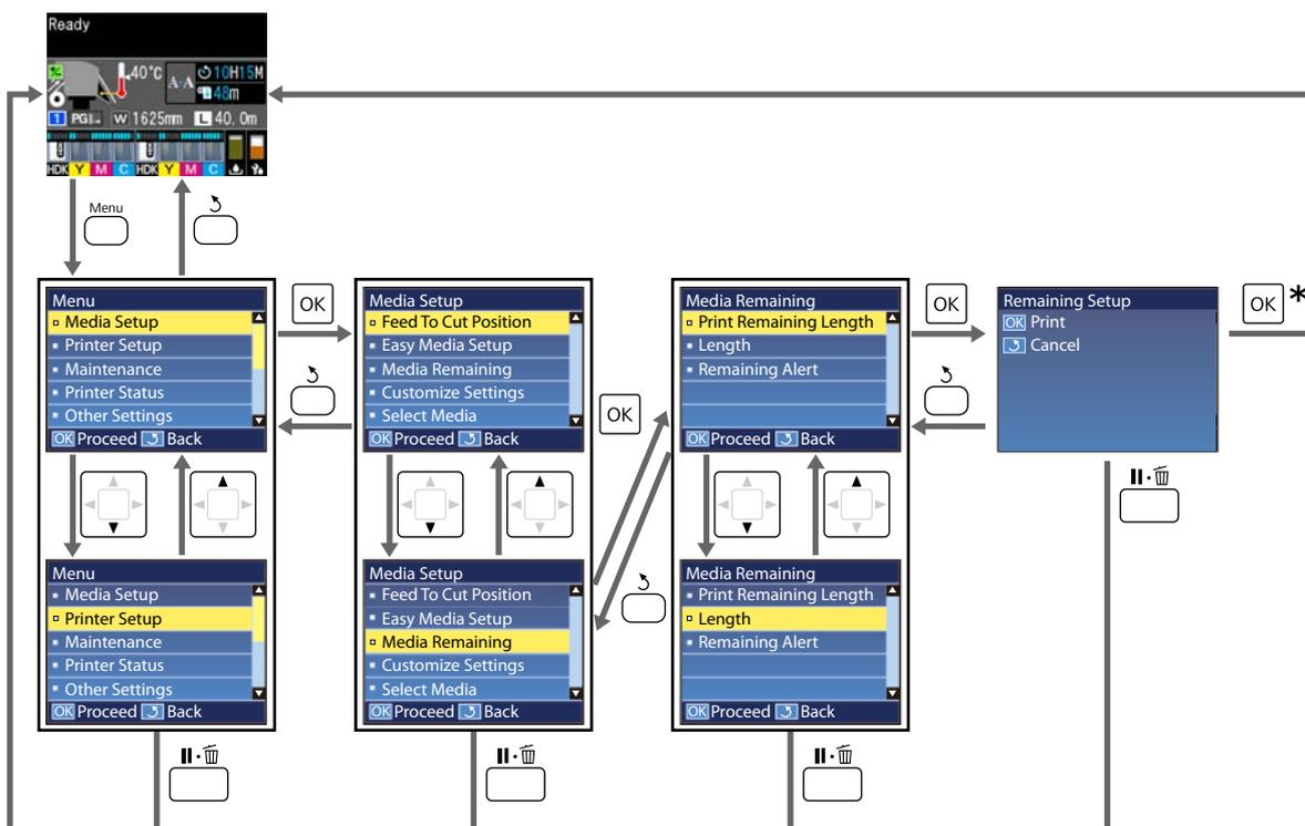
\* После завершения печати или регулировки, следующей за выбором элемента и нажатием кнопки ОК, отображается экран состояния.
