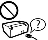
Utilizzare solo il cavo di alimentazione fornito con la stampante. L'utilizzo di un altro cavo potrebbe provocare un incendio o un cortocircuito. Non utilizzare il cavo per nessun'altra apparecchiatura.
