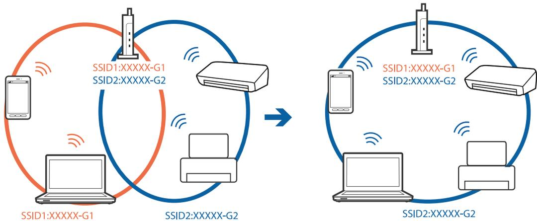
❑ إحدى نقاط الوصول المتوافقة مع كل من بروتوكول IEEE802.11a وبروتوكول IEEE802.11g لديها معرفات شبكة SSID تصل إلى 2.4 غيغا هرتز و5 غيغا هرتز. إذا قمت بتوصيل الكمبيوتر أو الجهاز الذي بمعرف شبكة SSID 5 غيغا هرتز، فسيتعذر عليك الاتصال بالطابعة لأن الطابعة تدعم فقط الاتصال لما يزيد عن 2.4 غيغا هرتز. قم بتوصيل الكمبيوتر أو الجهاز الذي بمعرف الشبكة SSID نفسه الذي تستخدمه الطابعة.
