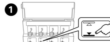
Visually check the ink levels of all ink tanks. If the ink level is below the lower line on the tanks, go to step ② to refill the tanks. Vérifiez visuellement le niveau d'encre de tous les réservoirs d'encre. Si le niveau d'encre est inférieur à la ligne inférieure des réservoirs, passez à l'étape ② pour les remplir.
