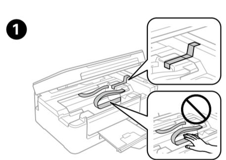
Secure print head with a tape. Fixez la tête d'impression avec de la bande adhésive. Fije el cabezal de impresión con cinta adhesiva. Fixe a cabeça de impressão com uma fita.
