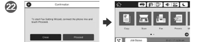
Po wyświetleniu się ekranu kreatora ustawień faksu dotknij przycisku Dalej, aby skonfigurować podstawowe ustawienia faksu. Aby skonfigurować ustawienia później, zamknij ekran kreatora ustawień faksu. Wyświetli się ekran główny i drukarka będzie gotowa do pracy.
