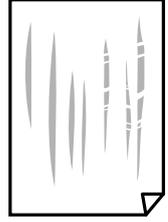
□ في حالة عدم زوال المشكلة بعد تنظيف مسار الورق، فإن الجزء المبين في الرسم التوضيحي والموجود داخل الطابعة يكون ملطخًا. قم بإيقاف الطابعة، ثم قم بمسح الحبر باستخدام قطعة قطن.
