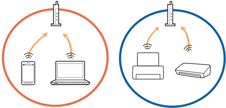
❑ قد يتعذر عليك الاتصال بنقطة الوصول عندما يكون لها العديد من معرفات الشبكة SSID وعندما تكون الأجهزة متصلة بمعرفات شبكة SSID مختلفة على نقطة الوصول نفسها. قم بتوصيل الكمبيوتر أو الجهاز الذكي بمعرف الشبكة SSID نفسه الذي تستخدمه الطابعة.
