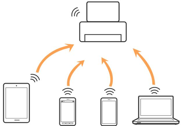
يمكن توصيل الطابعة عن طريق شبكة *Wi-Fi* واتصال *Wi-Fi Direct* (نقطة الوصول البسيط) في وقت واحد. وبالرغم من ذلك، إذا بدأت اتصال الشبكة في وضع اتصال *Wi-Fi Direct* (نقطة الوصول البسيط) عندما تكون الطابعة متصلة عن طريق شبكة *Wi-Fi*، فسيتم قطع الاتصال بشبكة *Wi-Fi* بشكل مؤقت.
