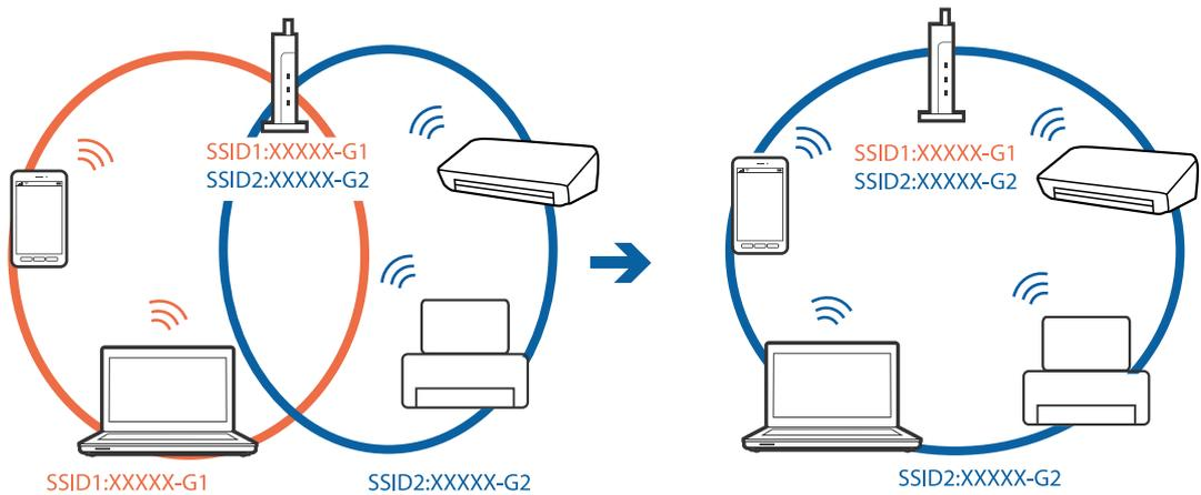
❑ إحدى نقاط الوصول المتوافقة مع كل من بروتوكول IEEE802.11a وبروتوكول IEEE802.11g لديها معرفات شبكة SSID تصل إلى 2.4 غيغا هرتز و 5 غيغا هرتز. إذا قمت بتوصيل الكمبيوتر أو الجهاز الذكي بمعرف شبكة SSID 5 غيغا هرتز، فسيستعذر عليك بالاتصال بالطابعة لأن الطابعة تدعم فقط الاتصال لما يزيد عن 2.4 غيغا هرتز. قم بتوصيل الكمبيوتر أو الجهاز الذكي بمعرف الشبكة SSID نفسه الذي تستخدمه الطابعة.
