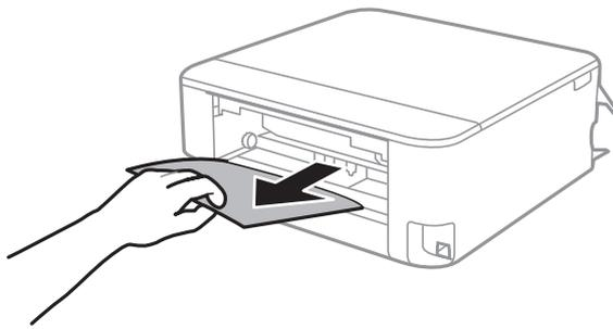
3. Entfernen von gestautem Papier über die hintere Abdeckung
