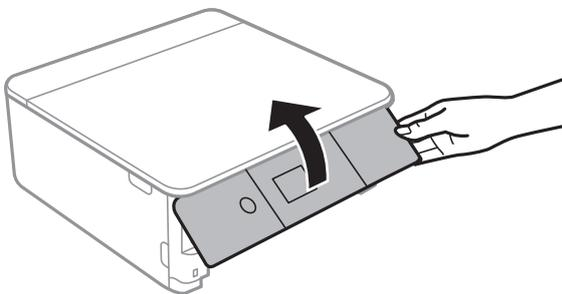
4. Lösen Sie die Schraube mit einem Flachschaubenzieher und entfernen Sie dann die Abdeckung.
