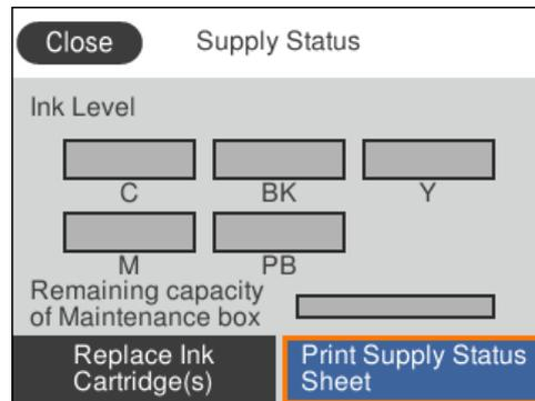
Sie können die ungefähren Tintenstände und die ungefähre Nutzungsdauer der Wartungsbox kontrollieren. Ebenfalls können Sie die Tintenpatronen ersetzen oder die Zufuhrstatusinformationen drucken.
