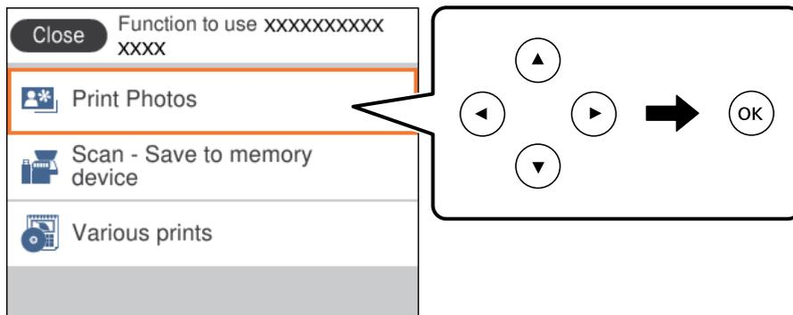
Bewegen Sie zum Auswählen eines Elements den Fokus mithilfe der Tasten ▲, ▼, ◀, ▶ auf das betreffende Element, und drücken Sie dann die Schaltfläche OK.
