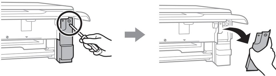
5. Retire la caja de mantenimiento usada.
