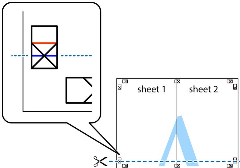
7. Coloque el borde de la Sheet 1 y la Sheet 2 encima de la Sheet 3 y la Sheet 4 y alinee las marcas de cruz. A continuación, pegue temporalmente las hojas por la parte de atrás.
