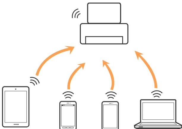
La stampante può venire simultaneamente connessa tramite Wi-Fi e in modalità Wi-Fi Direct (AP semplice). Tuttavia, se si inizia una connessione di rete in modalità Wi-Fi Direct (AP semplice) quando la stampante è connessa tramite Wi-Fi, la connessione Wi-Fi viene temporaneamente disconnessa.
