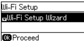
3. Seleccione el SSID del punto de acceso que se muestra en el panel de control de la impresora.
