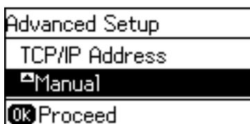
Ao definir o endereço IP automaticamente usando a função DHCP do router, selecione Auto. Nesse caso, o **Ender IP**, **Másc sub-rede**, e **Gateway predef.** no passo 6 a 9 também são definidos automaticamente, avance para o passo 10.
