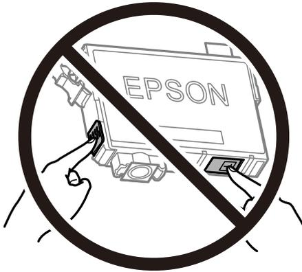
5. Apriete la lengüeta en el cartucho de tinta y tire de ella hacia arriba. Si no puede retirar el cartucho de tinta, tire de él con firmeza
