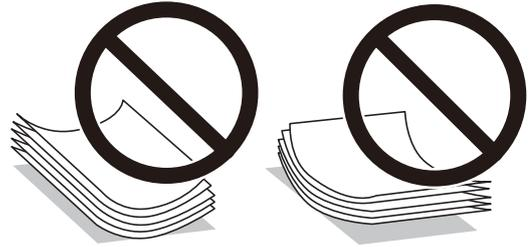
□ لا تستخدم الورق المجعد، أو الممزق، أو المقطوع، أو الملفوف، أو المبلل، أو السميك للغاية، أو الرفيع للغاية، أو الورق الذي يحتوي على ملصقات. قد ينتج عن استخدام هذه الأنواع من الورق انحشار الورق وتلطيخ الحبر على المطبوعات.
