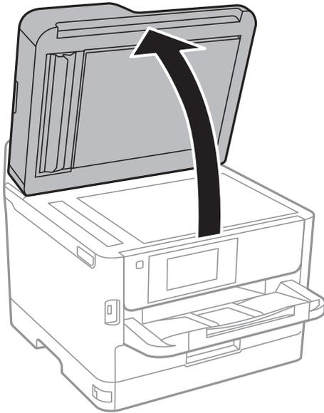
2. Reinigen Sie die Oberfläche des Vorlagenglases mit einem weichen, trockenen, sauberen Tuch.
