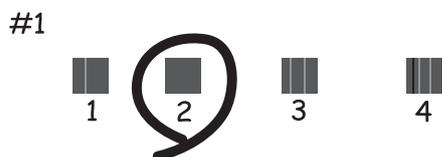
Finden und wählen Sie die Nummer für das Muster mit der am besten ausgerichteten vertikalen Linie.
