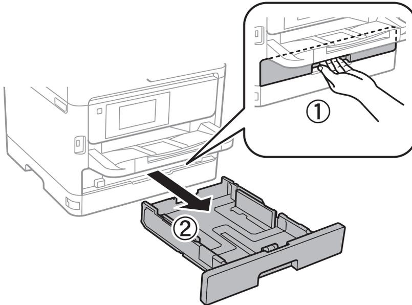
2. Schieben Sie die vordere Papierführungsschiene bis zur maximalen Position und richten Sie dann die seitlichen Papierführungsschienen am verwendeten Papierformat aus.
