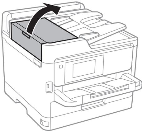
2. Reinigen Sie die Rolle und die Innenseite des ADF mit einem weichen, feuchten Tuch.
