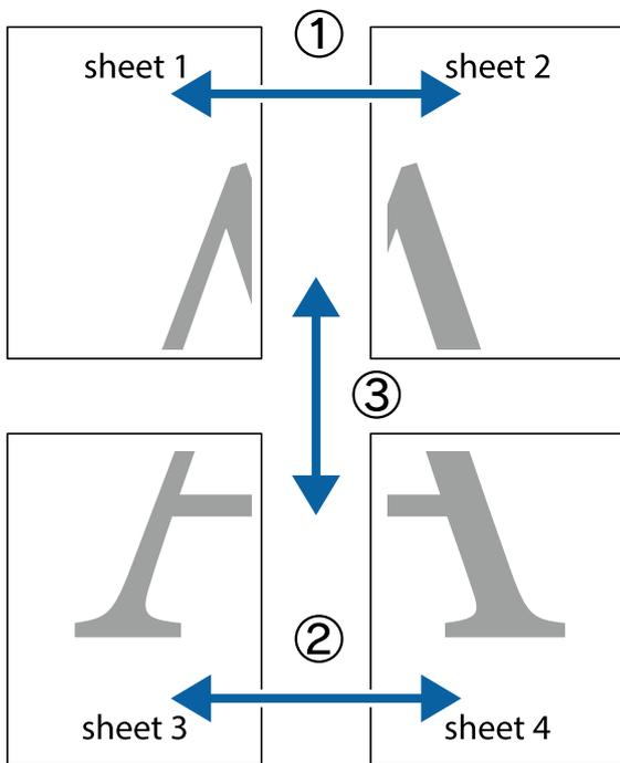
1. Bereiten Sie Sheet 1 und Sheet 2 vor. Schneiden Sie die Ränder von Sheet 1 entlang der vertikalen blauen Linie durch die Mitte der oberen und unteren Kreuzmarkierungen ab.
