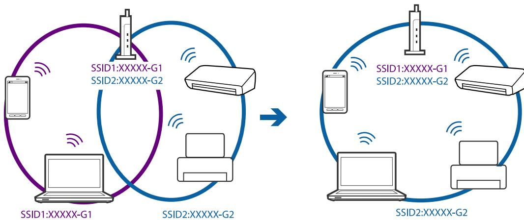
◻ تملك نقطة الوصول المترافق مع كل من IEEE802.11a و IEEE802.11g معرفات خدمة شبكة بمعدل 2.4 جيجا هرتز و 5 جيجا هرتز. إذا قمت بتوصيل جهاز الكمبيوتر أو الجهاز الذي يُعرف بخدمة شبكة بمعدل 5 جيجا هرتز، فلن تتمكن من الاتصال بالطابعة حيث إن الطابعة تدعم الاتصال بمعدل أكثر من 2.4 جيجا هرتز فقط. قم بتوصيل الكمبيوتر أو الجهاز الذي يُعرف بالشبكة SSID نفسه الذي تتصل به الطابعة.
