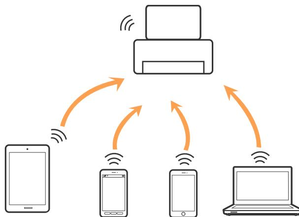
يمكن توصيل الطابعة عن طريق شبكة Wi-Fi واتصال Wi-Fi Direct (نقطة الوصول البسيط) في وقت واحد. وبالرغم من ذلك، إذا بدأت اتصال الشبكة في وضع اتصال Wi-Fi Direct (نقطة الوصول البسيط) عندما تكون الطابعة متصلة عن طريق شبكة Wi-Fi، فسيتم قطع الاتصال بشبكة Wi-Fi بشكل مؤقت.
