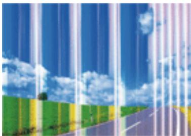
Дюзы печатающей головки могут быть забиты. Выполните проверку дюз для проверки состояния дюз печатающей головки. Если дюзы забиты, выполните очистку печатающей головки.
