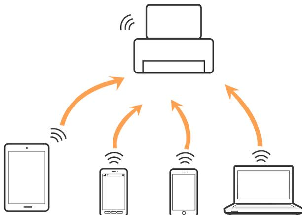
Принтер может иметь подключение к Wi-Fi и подключение Wi-Fi Direct (простая точка доступа) одновременно. Однако, если вы начнете передачу по сети с помощью подключения Wi-Fi Direct (простая точка доступа), если принтер подключен к сети Wi-Fi, сеть Wi-Fi будет временно отключена.
