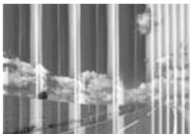
Los inyectores del cabezal de impresión pueden estar obstruidos. Ejecute un test de inyectores para comprobar si están obstruidos los inyectores del cabezal de impresión. Si hay algún inyector obstruido, limpie el cabezal de impresión.
