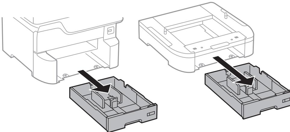
8. Se si utilizzano più unità cassetto opzionali, impilare tutte le unità cassetto carta opzionali una sopra l'altra e fissarle mediante le viti in dotazione.
