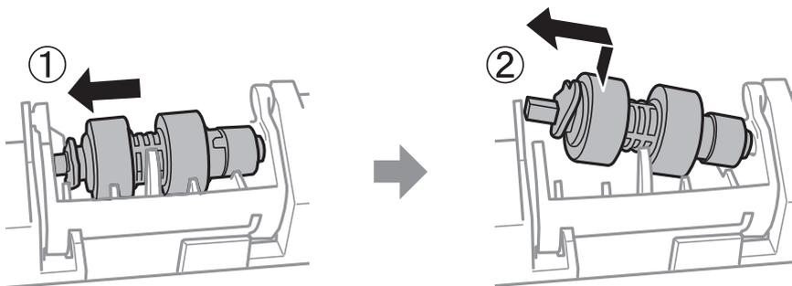
12. Inserire l'albero del nuovo rullo di manutenzione nel foro nel supporto, quindi far scorrere l'albero sul lato della leva lungo l'alloggiamento mentre è rivolta verso la superficie piatta nella parte anteriore.
