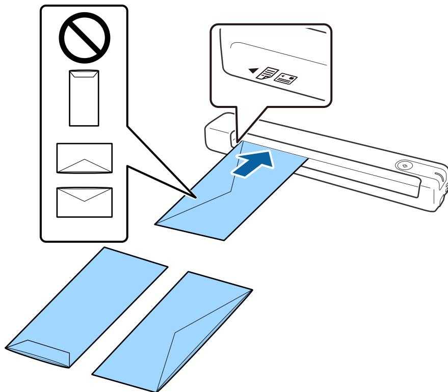
На конверті, показаному на малюнку, відкрита сторона (з клапаном) лицьовою стороною, але можна завантажувати конверти в сканер з відкритою стороною (з клапана) зворотньою стороною.
