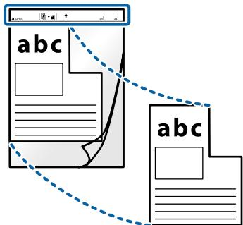
2. Завантажте Захисний футляр зліва у вхідний лоток, щоб верхній край аркуша був розміщений біля позначки сканера.
