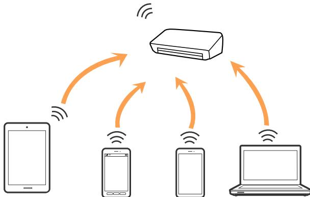
Сканер можна одночасно підключити через Wi-Fi або режим Wi-Fi Direct (Simple AP). Однак, якщо з'єднання з мережею буде запущене у режимі Wi-Fi Direct (Simple AP), коли сканер підключений до Wi-Fi, з'єднання Wi-Fi тимчасово зникає.
