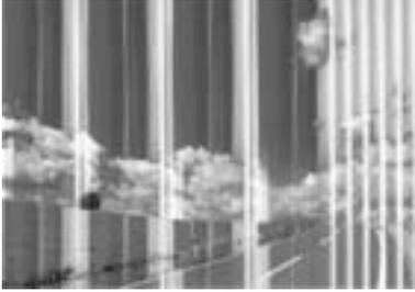
Os jatos da cabeça de impressão podem estar obstruídos. Efetue uma verificação dos jatos para ver se os jatos da cabeça de impressão estão obstruídos. Limpe a cabeça de impressão se algum dos jatos da cabeça estiver obstruído.
