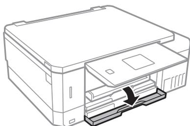
4. Vérifiez que l'imprimante n'est pas en cours de fonctionnement, puis retirez le bac papier 1. Le Bac papier 1 dispose d'un repère d'alignement
