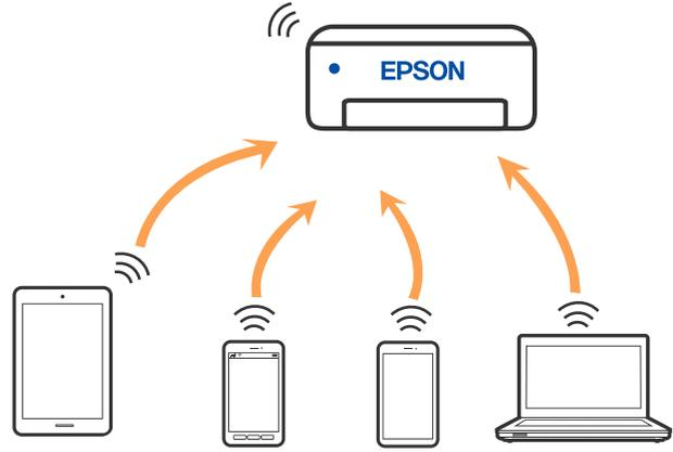
يمكن توصيل الطابعة عن طريق شبكة Wi-Fi واتصال Wi-Fi Direct (نقطة الوصول البسيط) في وقت واحد. وبالرغم من ذلك، إذا بدأت اتصال الشبكة في وضع اتصال Wi-Fi Direct (نقطة الوصول البسيط) عندما تكون الطابعة متصلة عن طريق شبكة Wi-Fi، فسيتم قطع الاتصال بشبكة Wi-Fi بشكل مؤقت.
