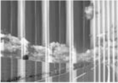
Die Druckkopfdüsen könnten verstopft sein. Drucken Sie ein Düsentestmuster, um zu überprüfen, ob Düsen verstopft sind. Reinigen Sie den Druckkopf, falls irgendeine der Druckkopfdüsen verstopft ist.
