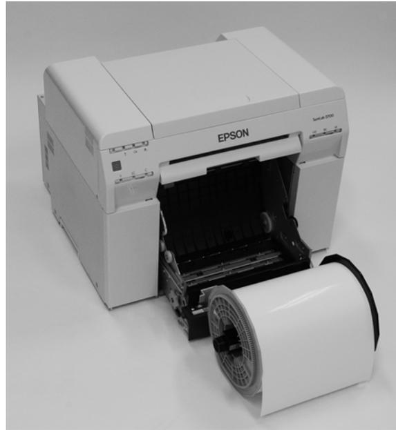
**3** Installare il perno nell'alimentatore rotolo.
