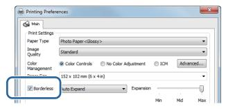
Выберите **Auto Expand (Автоматическое расширение)** или **Retain Size (Сохранить размер)** в качестве способа печати без границ.
