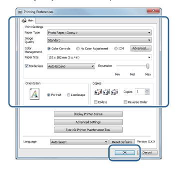
При проверке изображения, отображаемого на экране **Print Settings (Настройки печати)**, установите все настройки, такие как управление цветами и положение печати.
