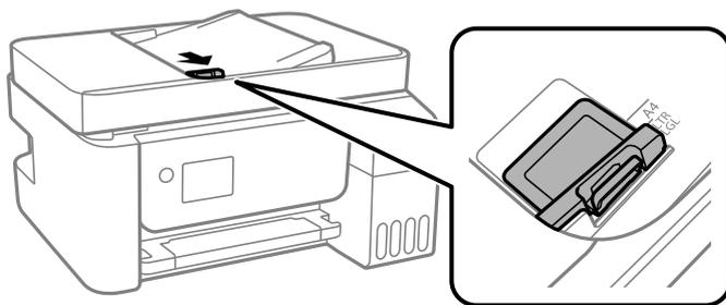
3. Coloque os originais com a face voltada para cima no ADF e, em seguida, desligue o guia de margem do ADF até à margem dos originais.
