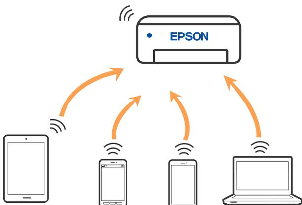
A impressora pode ser ligada por Wi-Fi ou Ethernet e Wi-Fi Direct (AP Simples) em simultâneo. No entanto, se iniciar uma ligação de rede em Wi-Fi Direct (AP Simples) com a impressora ligada por Wi-Fi, o Wi-Fi é desativado temporariamente.
