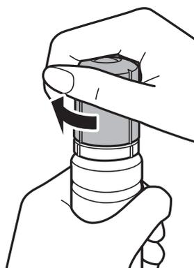
11. Feche a tampa do depósito de tinta de forma firme e a seguir pressione o botão
