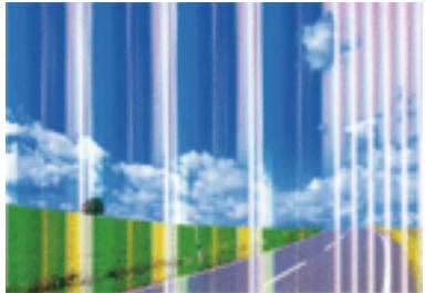
Το ακροφύσιο της κεφαλής εκτύπωσης μπορεί να είναι φραγμένο. Εκτελέστε έλεγχο ακροφυσίων για να διαπιστώσετε αν τα ακροφύσια της κεφαλής εκτύπωσης είναι φραγμένα. Καθαρίστε την κεφαλή εκτύπωσης σε περίπτωση που κάποιο από τα ακροφύσια της κεφαλής εκτύπωσης είναι φραγμένο.
