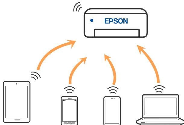
Μπορείτε να συνδέσετε ταυτόχρονα τον εκτυπωτή μέσω Wi-Fi και Wi-Fi Direct (Simple AP). Ωστόσο, αν ξεκινήσετε μια σύνδεση δικτύου σε λειτουργία Wi-Fi Direct (Simple AP) όταν ο εκτυπωτής είναι συνδεδεμένος μέσω Wi-Fi, το Wi-Fi αποσυνδέεται προσωρινά.
