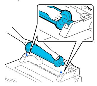
Deslize o eixo pelas ranhuras, e coloque ambas as extremidades do eixo nos respetivos suportes do eixo.
