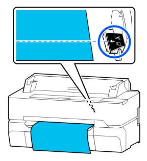
As linhas de corte não podem ser imprimidas dentro da página, antes da margem inferior. Quando terminar de mover o papel, toque em (Cortar). É exibido o ecrã de seleção de corte ou de impressão de linhas de corte.
