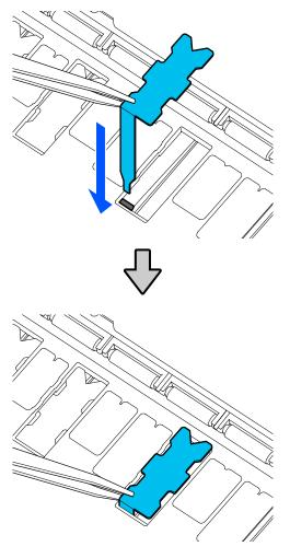
Empurre a saliência à esquerda e direita das almofadas para imprimir sem margens nas ranhuras à esquerda e à direita.
