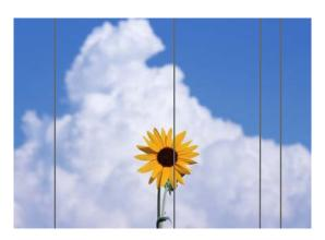
Чтобы выполнить чистку внутри сканера, следуйте указанным ниже инструкциям. Из-за пыли или грязи, прилипшей к роликам или поверхности стекла сканера, на результатах копирования и отсканированных изображениях могут появляться нежелательные линии или пятна.
