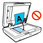
□ При наличии документов на стекле и в автоматическом податчике документов будет отсканирован документ, расположенный в податчике.
