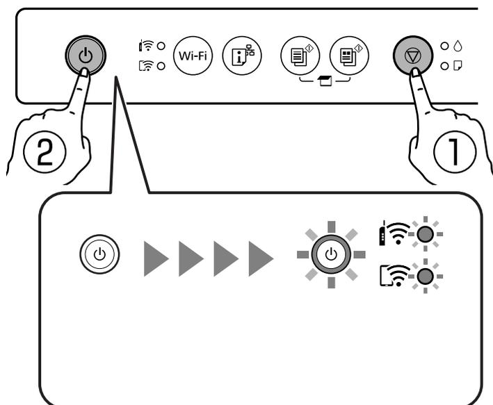
Se imprimirá el patrón del test de inyectores.
