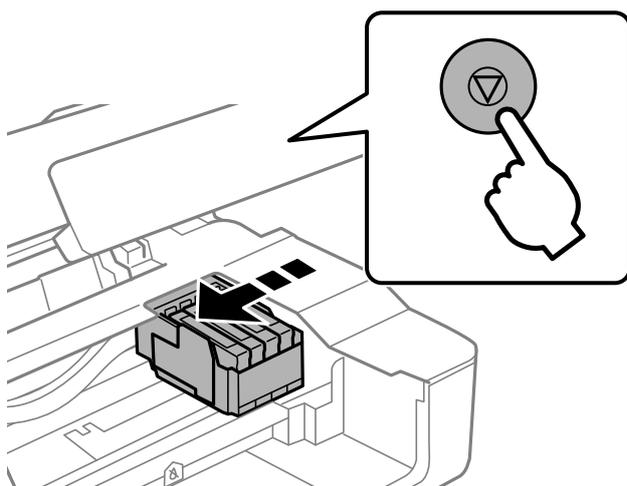
El soporte del cartucho de tinta se desplazará a la posición de sustitución.
