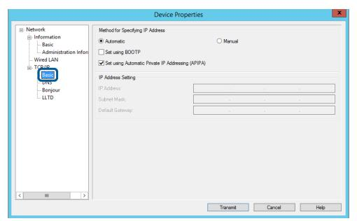
Inserire gli indirizzi per IP Address (Indirizzo IP), Subnet Mask (Maschera sottorete) e Default Gateway (Gateway predefinito).
