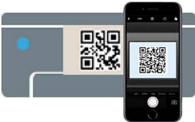
Verwenden Sie die Kamera-App für iOS 11 oder neuer. Die Verbindung zum Drucker mit der Kamera-App ist bei iOS 10 oder älter nicht möglich. Auch ist die Verbindung mit einer App zum Scannen von QR-Codes nicht möglich. Wenn Sie keine Verbindung herstellen können, drücken Sie die Taste ◀. Informationen zum Herstellen einer Verbindung finden Sie unten im Abschnitt „Zugehörige Informationen“.
