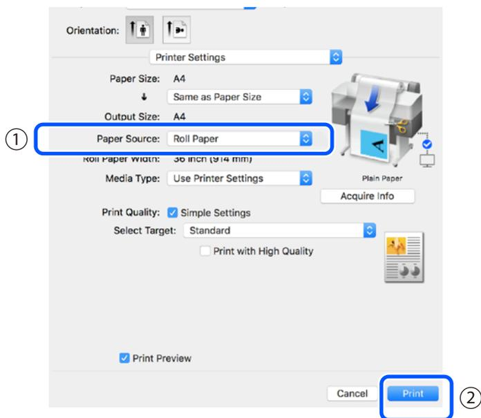
Aunque no se establezca nada en el controlador de la impresora, los datos de impresión se invierten (reflejan) y se imprimen. La impresión no se invierte si selecciona la casilla de verificación **Mirror Image (Espejo)**.
